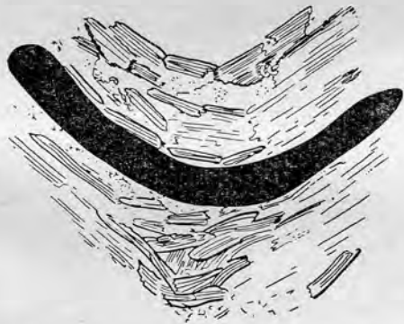
Фиг. 106. Паракристаллизационная деформация, выразившаяся в деформации чешуек слюды ниже изогнутой пластинки железной руды и в отсутствии нарушений в ядре изгиба; увеличено приблизительно в 15 раз (схематично по Зандеру).
