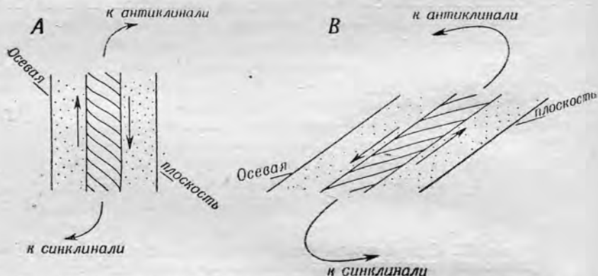
Фиг. 69. Вертикальный разрез, показывающий сланцеватость в некомпетентных пластах, залегающих между компетентными пластами. Направление скольжения по плоскости напластования, вытекающее из положения сланцеватости, показано стрелками.
