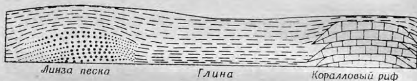
Фиг. 7. Схематический разрез, иллюстрирующий развитие куполов над линзами песчаника и коралловыми рифами, обусловленное большим уплотнением глины. Масштаб произвольный.
