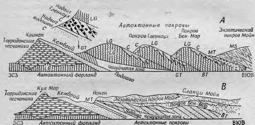
Фиг. 29. Схематический разрез через северо-западное нагорье Шотландии, показывающий надвиговые покровы и чешуйчатые структуры (по Уиллису). MS—сланцы Мойн; С—кембрий; TOR—торридонские песчаники; LG—льюисские гнейсы; GT—надвиг Гленкоул; BT—надвиг Бен-Мар; MT—надвиг Мойн. Дополнительная врезка показывает деталь чешуйчатой структуры.
