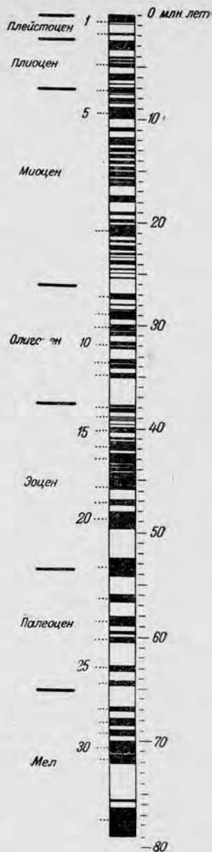
Рис. 50. Ламонтская шкала инверсий магнитного поля [90]. Слева направо: фанерозойская шкала геологического времени, номер аномалии, магнитная полярность (нормальная полярность показана черными отрезками рядом с колонкой).
