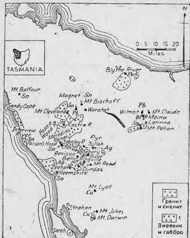
Рис. 20. Эскиз главной рудоносной области Северо-западной Тасмании с изображением интрузивных змеевиков и более поздних гранитов. Осмий-иридий и хром связаны с змеевиками. Оловянные руды находятся внутри и вблизи гранита, а свинцовые руды — на большем расстоянии. Зональность выражена в Химскирк, Парсоно-Худ, горе Бишоп и Мойна (по данным Уоллера, Туэлвтрис и Джонстона).
