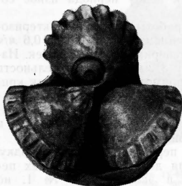
Рис. 22. Долото 1У-97Т № 918, отработанное на стенде при P_{ос}=3000 кг и n=238 об/мин.
