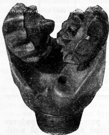
Рис. 32. Долото 1В-112МГ № 425, отработанное роторным способом в скв. 825 Изюмской площади в интервале 1141—1157 м.
