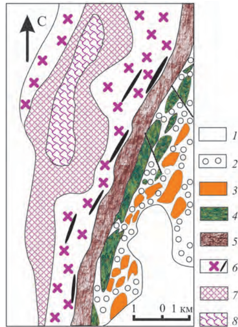
Рис. 3.16. Схематическая геологическая карта Нуралинского массива (составлена по материалам Г.Б. Рудника (1965), Г.Н. Савельевой (1988) и нашим наблюдениям): 1 – наносы; 2 – серпентинитовый цемент меланжа; 3 – сиенитодиориты, граносиениты и комагматичные им вулканиды С 1 ; породы расслоенной залежи: 4 – роговообманковые габбро, диориты, 5 – верлиты, клинопироксениты; 6 – гарцбургиты с телами дунитов (черное); 7 – шпинелевые лерцолиты; 8 – плагиолерцолиты
