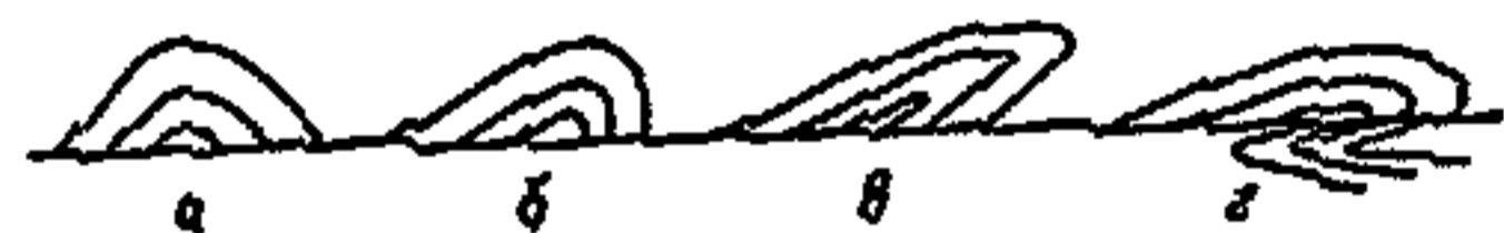
Рис. 80. Типы складок, выделенные по отношению к горизонту осевой поверхности а—прямая; б—косая; в—опрокинутая; г—лежащая
