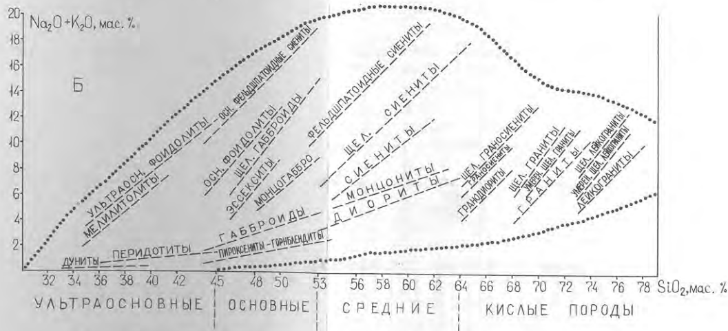
Рис. 2. Положение семейств магматических горных пород на TAS-диаграмме.
