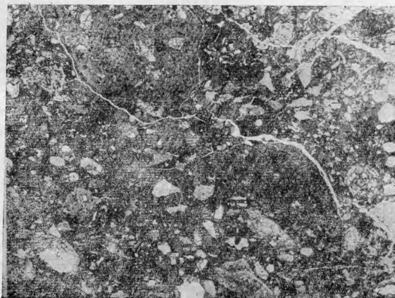
Рис. 49. Туфобрекчия основного состава с обломками авгититов, порфиритов и кристаллов пироксена. Увел. 10, без анализатора. Колл. Н. А. Румянцевой, Урал.
