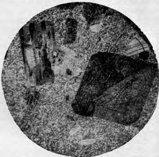
Рис. 95. Микроструктура сиенит-порфира. Виден крупный сдвойникованный вкрапленник ортоклаза и более мелкие вкрапленники плагиоклаза. Увел. 27, николи +. Колл. А. А. Прияткина.
