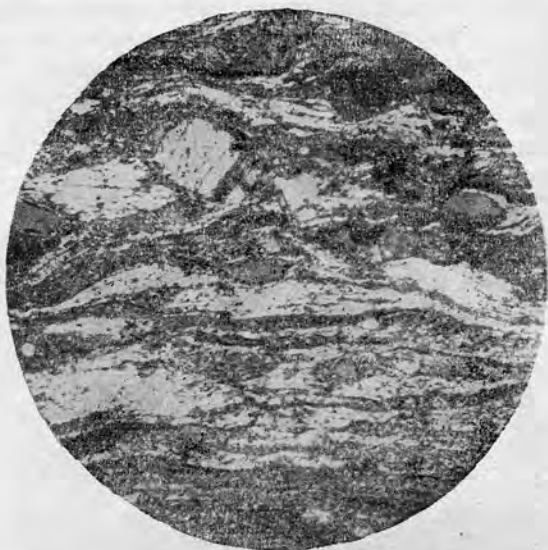
Рис. 124. Структура грубо-полосчатого милонита, видны порфирокласты кварца и полевого шпата. Западное Приладожье, Увел. 17, без анализатора.
