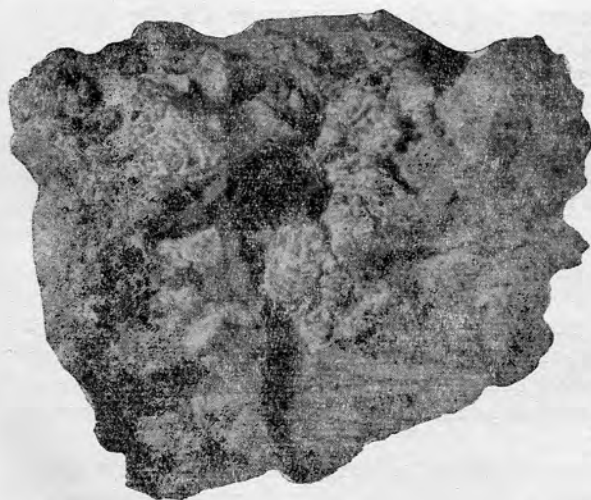
Рис. 132. Шлаковая текстура в горелом (переплавленном) глинистом сланце. Уменьшено в 2 раза. О. Берхауз. Колл. Л. П. Пирожникова.
