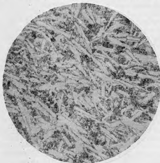
Рис. 43. Интерсертальная структура в базальте Сибири. Темные участки без шагрени — вулканическое стекло. Увел. 27, без анализатора.
