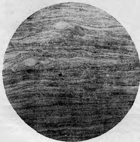
Рис. 123. Структура тонкополосчатого милонита. Увел. 17, без анализатора. Северо-Западное Приладожье.
