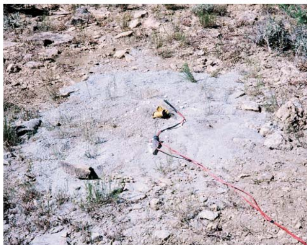
Рисунок 6.9. Засыпанная взрывная скважина.
