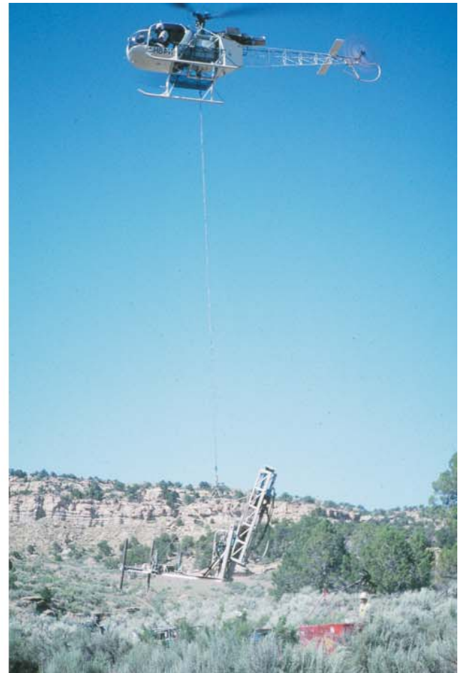
Рисунок 6.4. Транспортировка буровой установки вертолётom.
