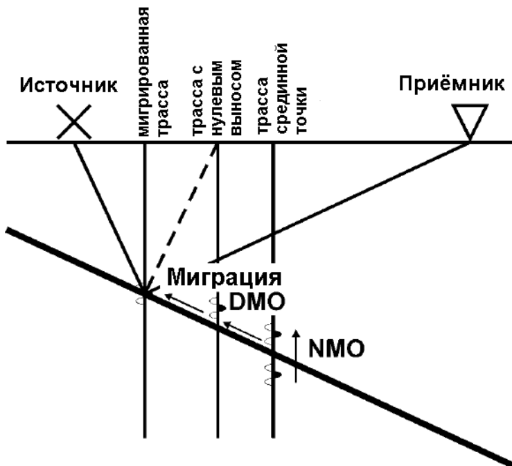
Рисунок 10.10. Перемещение данных во время NMO, DMO и миграции (по Шерифу, 1991).
