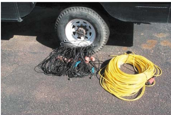
Рисунок 7.2. Смотанная линия геофонов и кабели, используемые в сейсмической съёмке.
