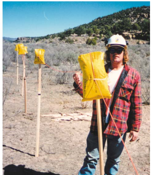
Рисунок 6.13. Групповой источник Poulter.
