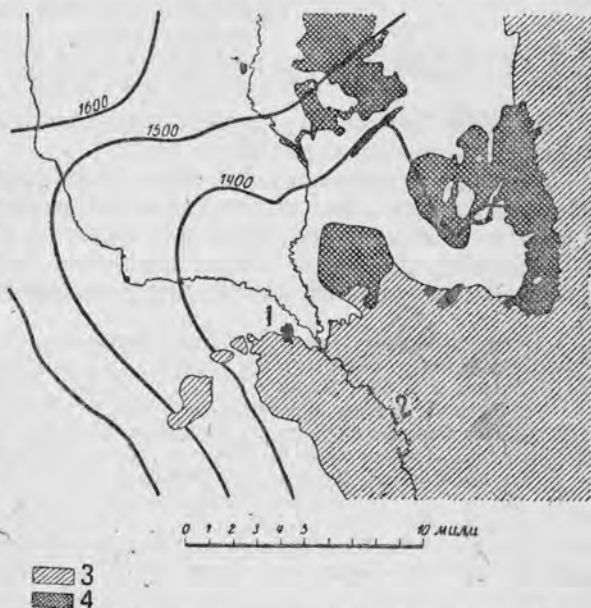
Рис. 89. План в гидроизогипсах грунтовой воды в артезианском бассейне Южной Дакоты (по Тодду и Голлу). 1 — Митшель; 2 — Джекс-Ривер; 3 — район с зеркалом грунтовых вод, лежащим под поверхностью земли; 4 — район с самоизливающимися артезианскими водами.
