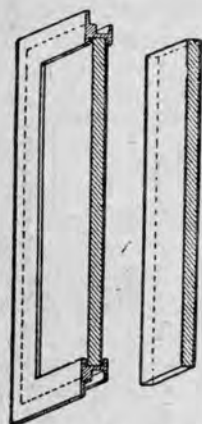
Рис. 272. Стекло-вые пластинки для каптажа воды в мелких песках (по Путзейсу).
