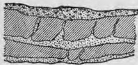
Рис. 189. Трещиноватый песчаник, наполненный мелким песком.
