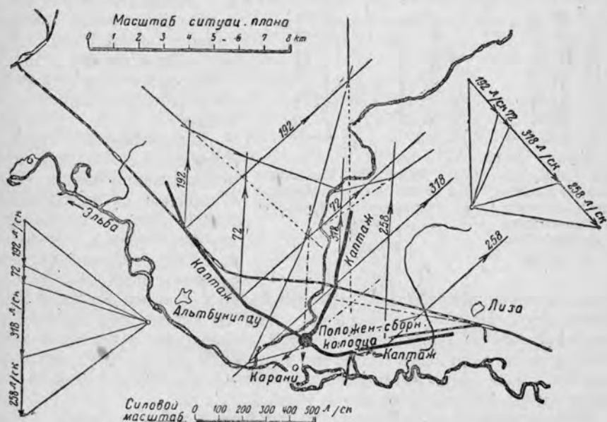
Рис. 292. Графическое определение положения сборного колодца.
