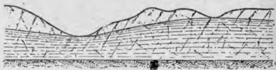
Рис. 88. Трещиноватая горная порода, с сплошной сетью волосных и мелких трещин, в которой образуется сплошное зеркало грунтовой воды.
