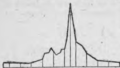
Рис. 106. Теоретический ход опыта с соляным раствором при одной пике.
