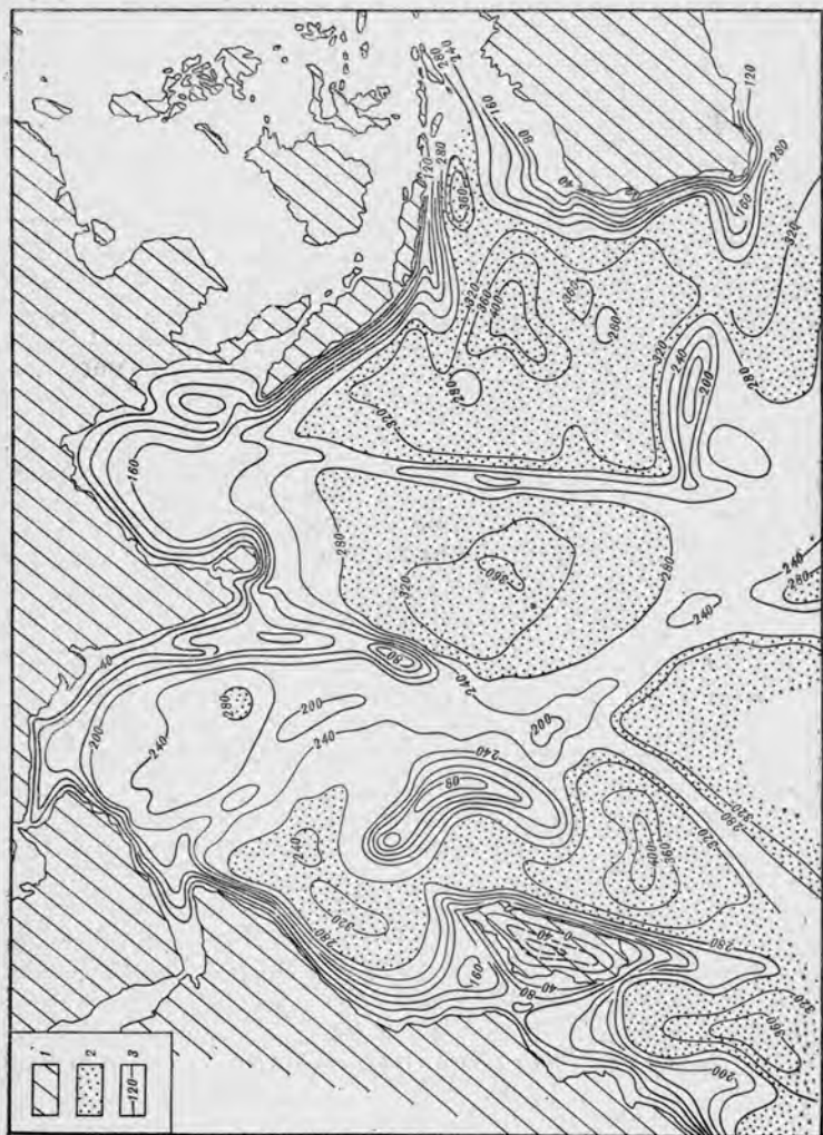
Рис. 43. Аномалии силы тяжести в Индийском океане в редуции Буге (по А. Г. Гайдарову, Е. Д. Корякину, П. А. Строву) 1 — матернки; 2 — гравитационные максимумы (более 280 мгг); 3 — изоаномалы (мгг)
