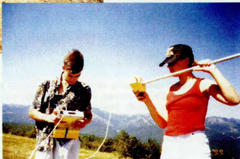
Рис. 18 Студенты-геофизики проводят магнитометрическую съемку вокруг дольмена на вершине г. Нексис
