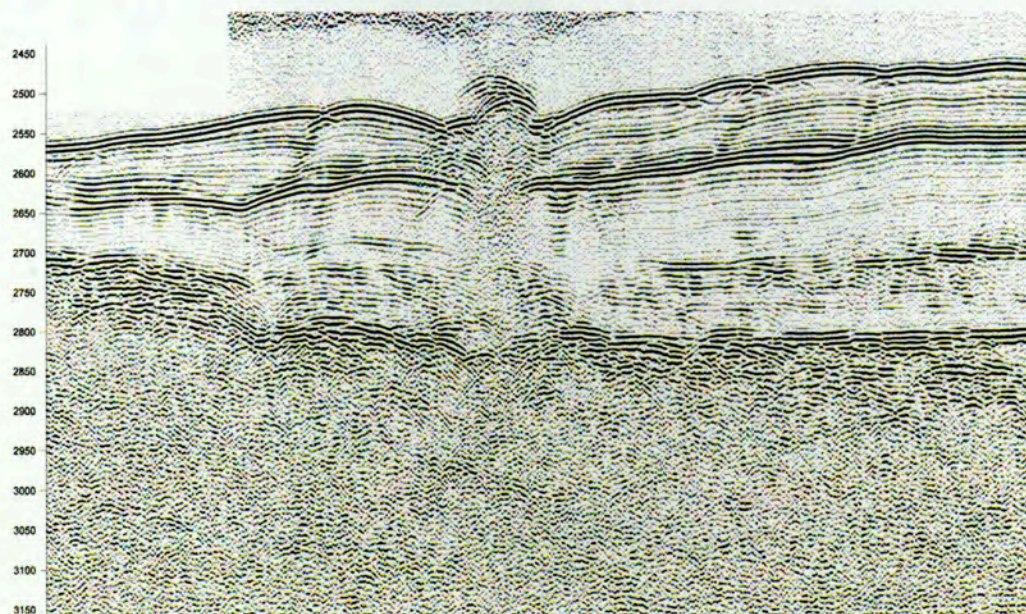
Рис.41. Временной разрез сейсмоакустического профилирования через грязевой вулкан Эколог в Черном море (по Андрееву В.М., Туголесову Д.Д.,Хренову С.Н.,2005)
