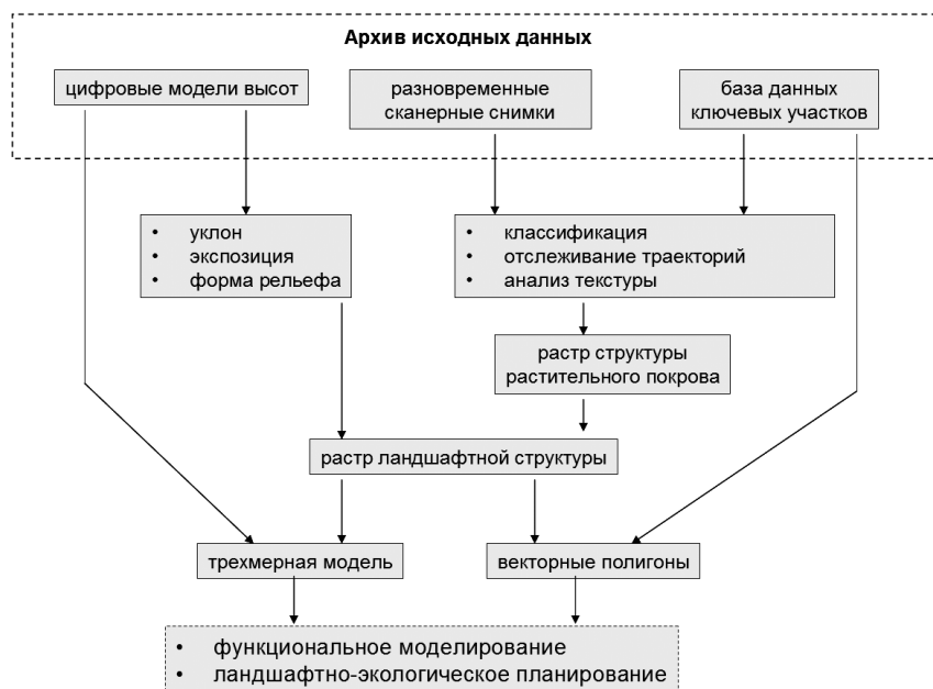
Рис. 71. Структурно-функциональная схема ландшафтно-экологической ГИС
