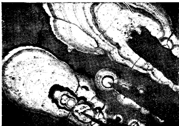
Рис. 6. Сферолиты гематита на кристаллах марганцовистого кальцита МК_1 (продольный разрез; микрофото полированного шлифа; николи параллельны; \times 70 ).
