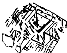
Рис. 3. Решетчатые сростки рутила (по ильмениту) в измененном альбитофиге. Ромбовидные зерна — циркон (полированный шлиф; \times 175 ).
