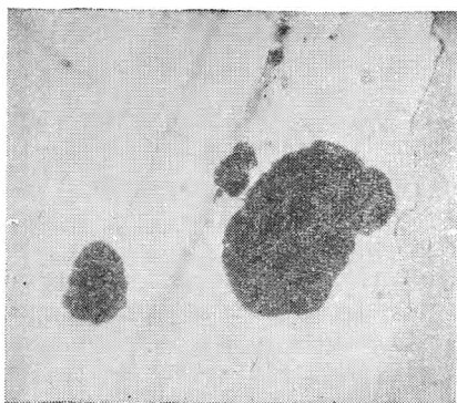
Рис. 5. Округлые желваки антраксолита в обр. № 146 кальцита (фото; полированный кристалл кальцита; \times 10 ).
