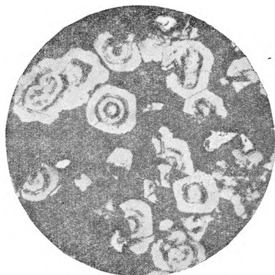
Рис. 5. Зональные кристаллы уранинита (отраженный свет; \times 200 ).
