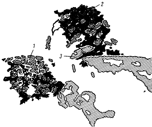
Рис. 10. Пластинчатые зерна ильменита (1), частично замещенные агрегатом кристаллов браннерита (2) и гематита (3) (полированный шлиф; \times 350 ).
