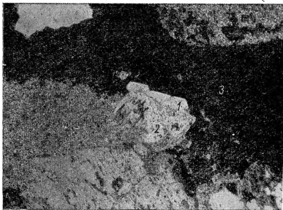
Рис. 9. Каемка воднопрозрачных кристаллов альбита (1), нарастающих на зерно измененного плагиоклаза (2) на контакте с прожилком настурана (3) (шлиф прозрачный; при одном николе; \times 70 ).
