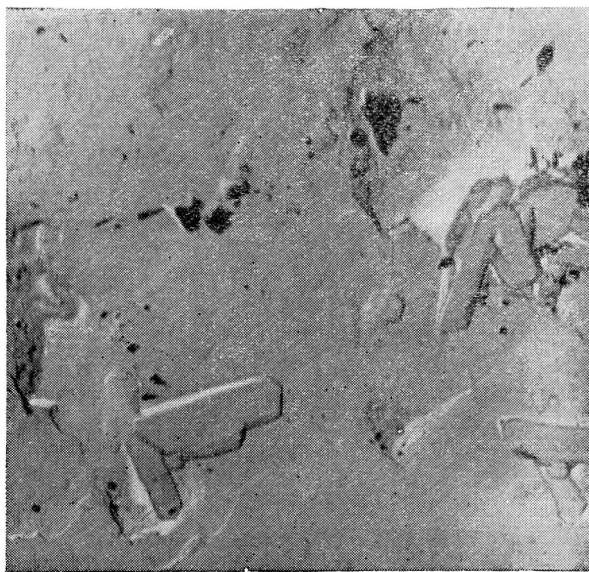
Рис. 4. Призматические кристаллы и колеччатые двойники рутила (?) в браннерите (электронно-микроскопический снимок; \times 8000 ).
