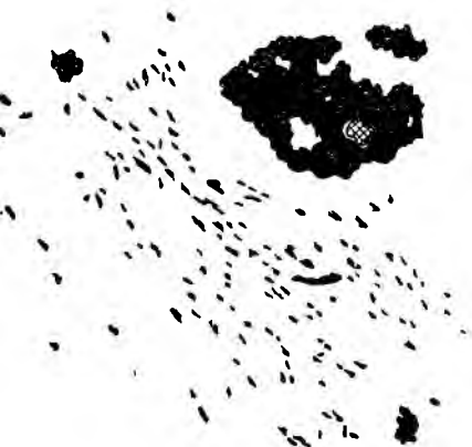
Рис. 17. Скопление мельчайших выделений браннерита таблитчатой и неправильной формы. Присутствует галенит (заштрихован; \times 230 ).
