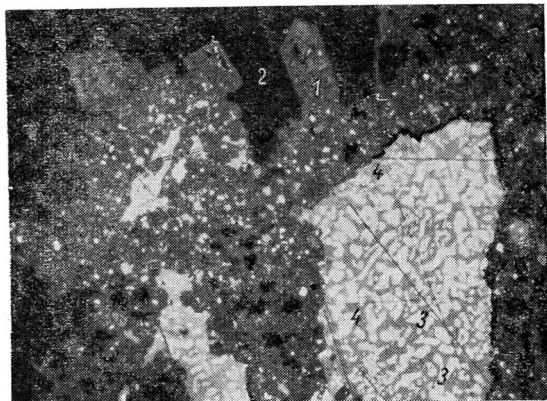
Рис. 13. Псевдоморфозы настурана (1) по коффиниту в кальците (2); мирмекитовые сростания галенита (3) с дигенитом (4) (аншлиф; \times 115 ).
