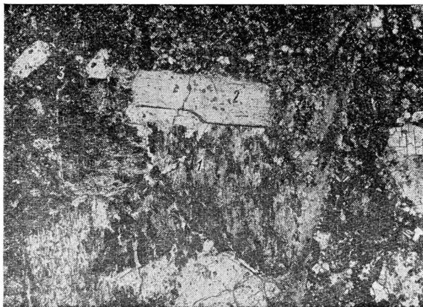
Рис. 11. Замещение вкрапленников калиевого полевого шпата настураном (шлиф прозрачный; при одном николе; \times 70 ):
