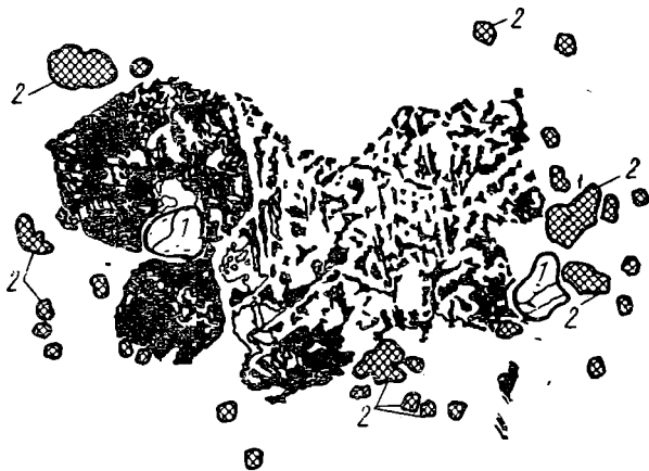
Рис. 2. Скопление тонкопластинчатых кристалликов браннерита, заместивших решетчатый сросток рутила (полированный шлиф; \times 175 ).
