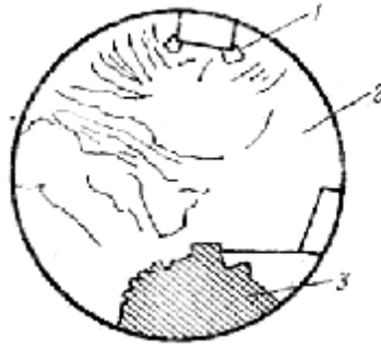
Рис. 5. Схема усталостного излома детали:
