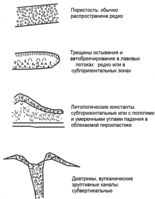
Рис. 3.1 Первичная проницаемость в вулканических породах.
