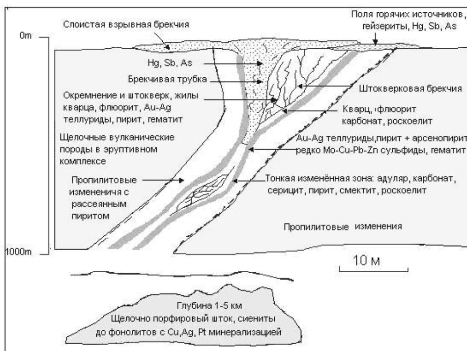
Рис. 7.3. Схематическая модель щелочного Au-Ag месторождения.
