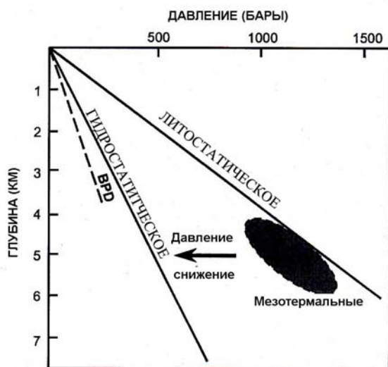
Рис.8.9. График давление-глубина для мезотермальных рудоносных гидротерм. Литостатическая линия представляет градиент давлений, допускаемый при плотности пород 2.7. Гидростатическая линия представляет этот же градиент, использующий плотность 1 (т.е. холодной воды). Кривая Р показывает точку кипения в зависимости от градиента глубины для чистой воды. Переход давления от литостатического к гидростатическому сопровождается отложением минералов.
