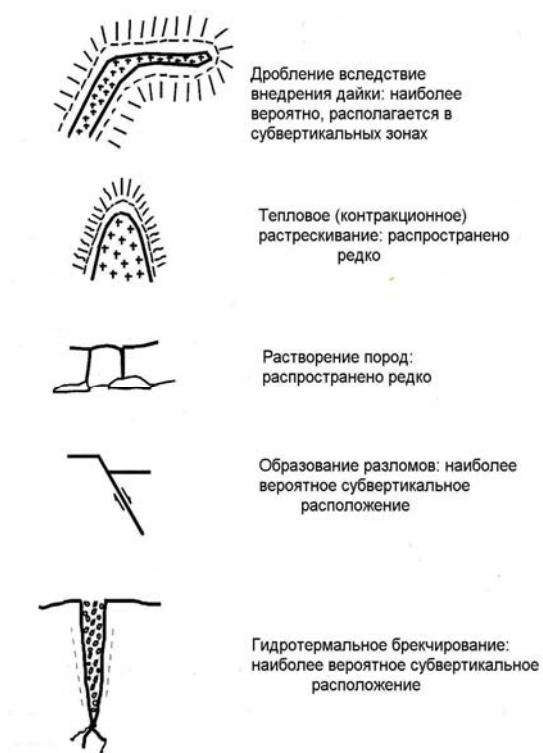
Рис. 3.2. Вторичная проницаемость в вулканических породах.
