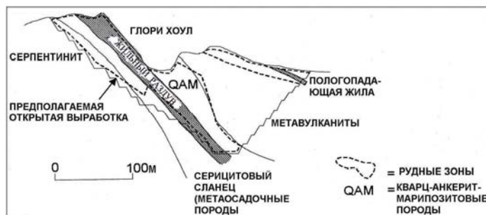
Рис.8.15. Поперечный разрез через месторождение Карсон Хилл, Мотерлоуд, Калифорния. Центральная мощная обычно с не рудоносным раздутием жила окружена зоной гидротермальных изменений серицитовых сланцев (подошва) и кварц-анкерит-марипозит - содержащими метавулканитами (висячий бок). Общая мощность этой гидротермально-изменённой/рудноносной зоны составляет примерно 50 м. Отмечается, что рудоносная минерализация связана с пологой жилой (Cartwright, Flitcroft, 1989).
