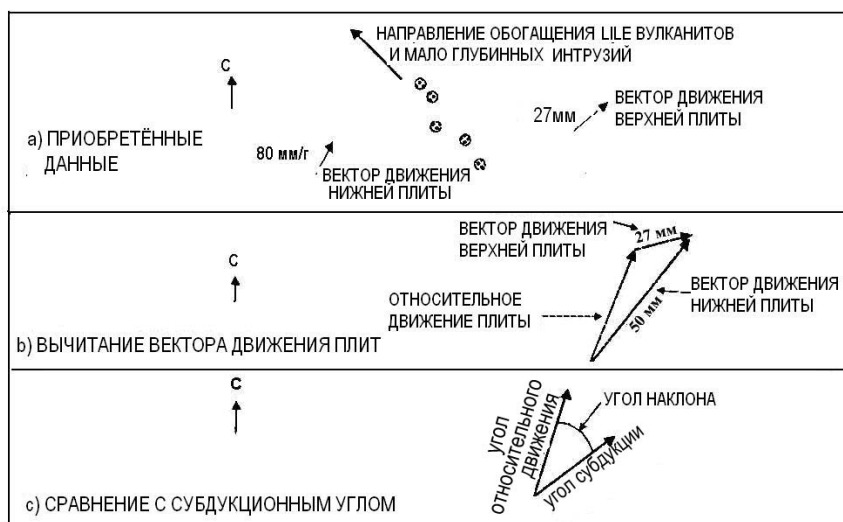
Рис. 16.4. Расчёт наклона субдукции островной дуги.
