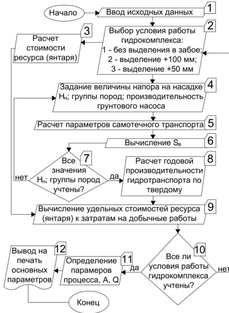
Рисунок 7 – Блок-схема алгоритма выбора параметров технологии при включении аппарата по извлечению наиболее крупных и ценных фракций янтаря
