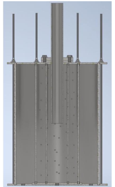
Рисунок Д.1 – Стенд для физического моделирования процессов ликвидации рапопроявлений [76]
