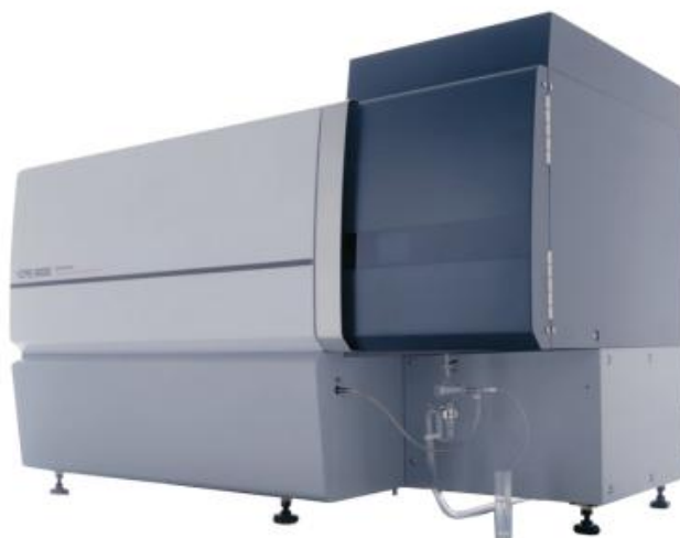
Рисунок 2.2 – Атомно-эмиссионный спектрометр ICPE-9000 фирмы Shimadzu Образцы проб рапы, отобранной с разных интервалов скважины №75 Ковыктинского ГКМ, представлены на рисунке 2.3.
