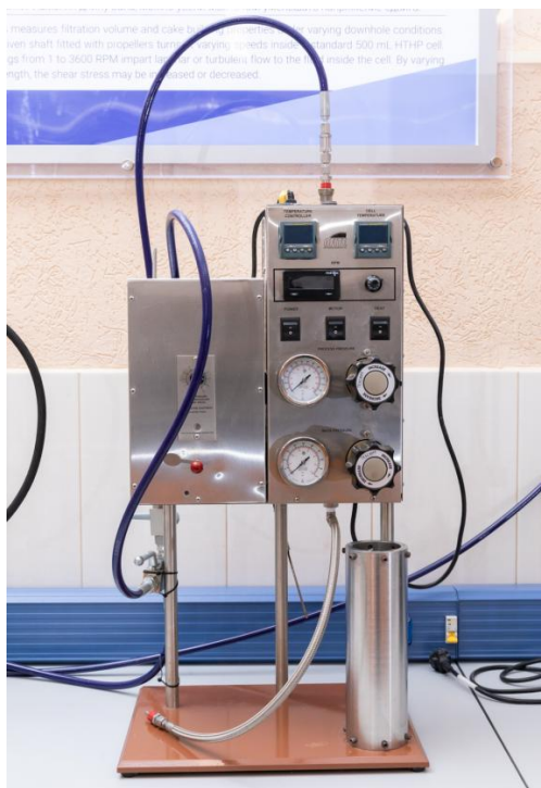
Рисунок 2.6 – Динамический фильтр-пресс НТНР (OFITE)
