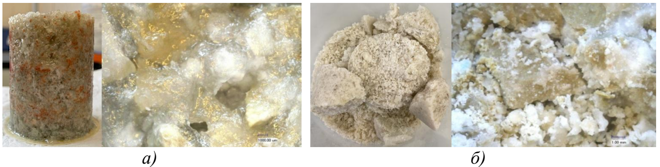
Рисунок 3.7 – Внешний вид насыпной модели после закачивания разработанного состава а) прочная модель; б) непрочная
