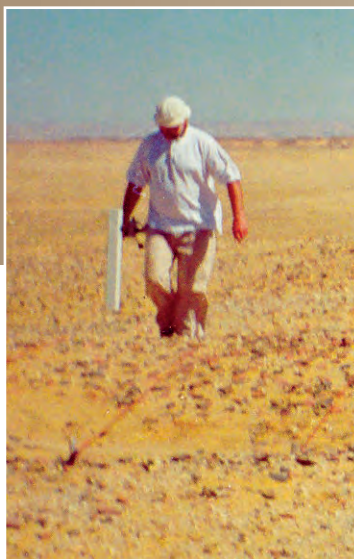
Польский археолог и геофизик доктор Томаш Хербич делает магнитную разведку в оазисе Дахла в Египте с помощью феррозондового градиентометра Geoscan FM-36
