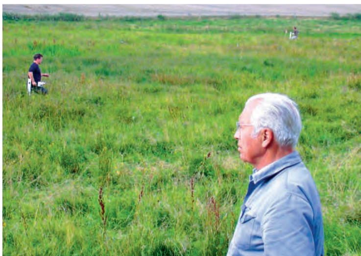
Нидам (Дания). Магнитная съемка проводится группой из Йорка с помощью двух феррозондовых магнитометров
