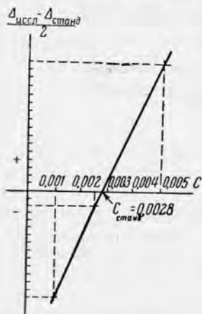
Рис. 3. Кривая для нахождения c_{\text{станд}} .
