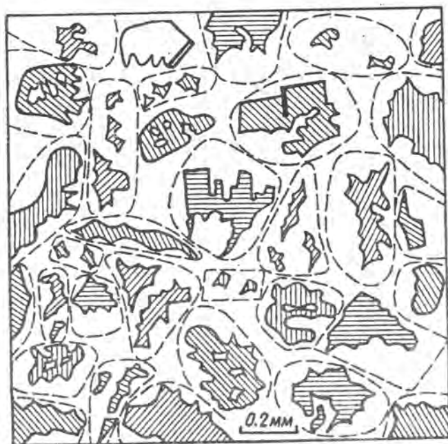
Рис. 30. Шлиф мелового песчаника на Гиссарском хребте, испытывавшего после погружения подъем до зоны A_2 (см. рис. 28); кальцит активно корродирует силикаты, до полного метасоматического замещения, и при этом образует вторичный пойкилитовый цемент; пунктиром намечены реликтовые контуры, [20]
