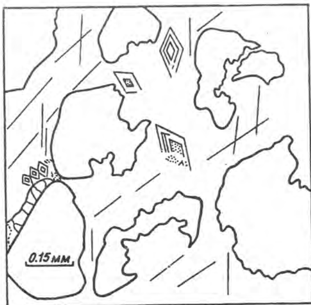
Рис. 31. Шлиф юрского кварцевого песчаника, находящегося в подзоне A_2 (см. рис. 28). Кальцитовый пойкилитовый цемент корродирует обломки; по нему развиваются ромбоздры доломита; по [20]
