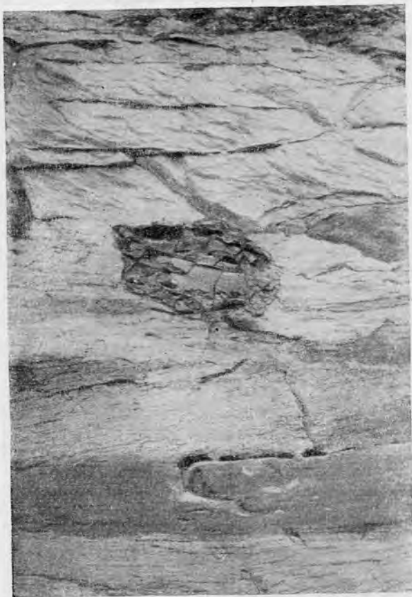
Рис. 11. Песчаники тимердянской свиты (верхний мел), заключающие крупный (до 0,4 м) угловатый переотложенный обломок плотных глинистых алевролитов. Река Вилюй — уроч. Кирилестях.
