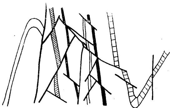
Рис. 91. Растяжение крыла складки, выраженное в системе разрывов. Кузбасс (по А. Белицкому)
