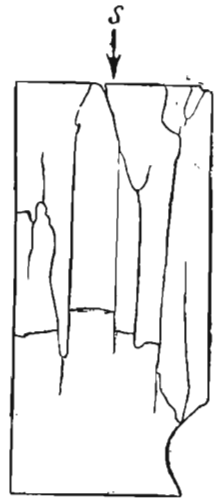
Р и с. 97. Разрывы растяжения, параллельные направлению сжатия (известняк из Золенхофена, разрушившийся при внешнем давлении около 100 атм.). Чертеж по фотографии. По Григгсу [45].
