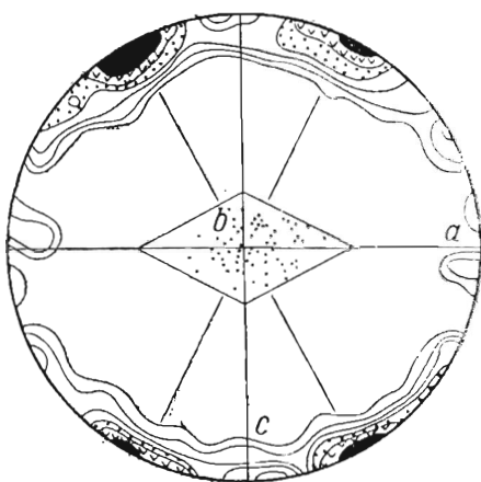
Рис. 42. 164 полюса слайности (110) в роговой обманке из габбро-амфиболита возле Боцена, Южный Тироль. Контуры 6—4—3—2—1—0,5%. В центре диаграммы—82 оси c_v тех же зерен. С изменениями по Зандеру [105].
