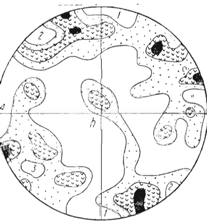
Р и с. 51. 222 оси зерен кварца из филлита (рис. 49). Цифры указывают минимумы осей и имеют то же расположение, что и на двух предшествующих рис. 49, 50. С изменениями по Зандеру [105].
