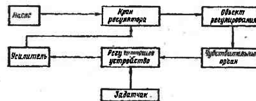
Рис. 42. Схема автоматического регулирования режима промывки скважины
