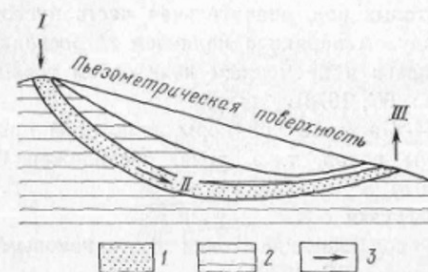
Рис. 35. Схема инфильтрационной водонапорной системы. Области: питания (I), создания напора и стока (II), разгрузки (III). 1 — породы-коллекторы; 2 — породы-водоупоры; 3 — направление движения вод
