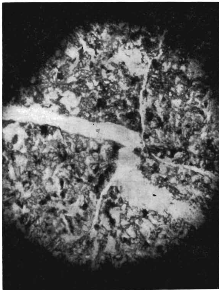
Рис. 2. Микротрещины в шлифе порфирового базальта, ув. 70 (по Л. В. Шаумяну)
