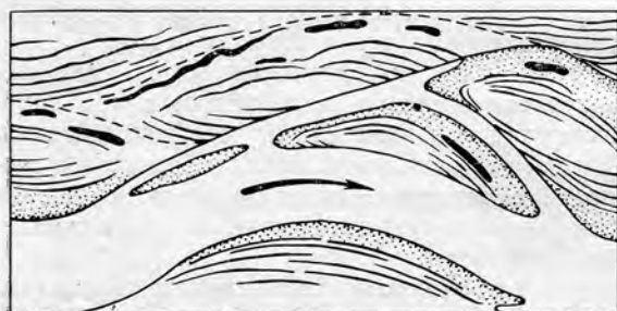
Рис. 43. Схема ориентировки гряд и кос в пойме реки, дробящейся на рукава (нижняя и верхняя стороны рамки соответствуют границам поймы) (по Е. В. Шандеру, 1951).
