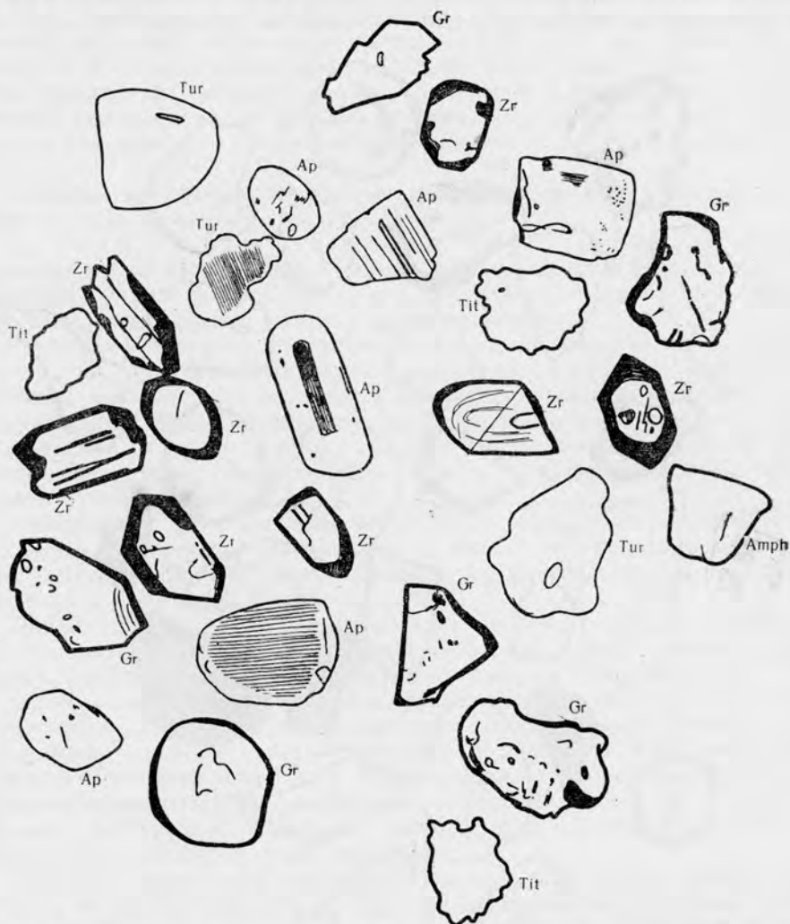
Рис. 20. Тяжелая фракция (0,4—0,05 мм) песчаника из отложений аалена Усть-Енисейской впадины в иммерсионной жидкости с N = 1,638 (обр. № 263). Ap — апатит; Amph — амфиболы; Gr — гранат; Zr — циркон; Tur — турмалин; Tit — титанистые неопределимые минералы.
