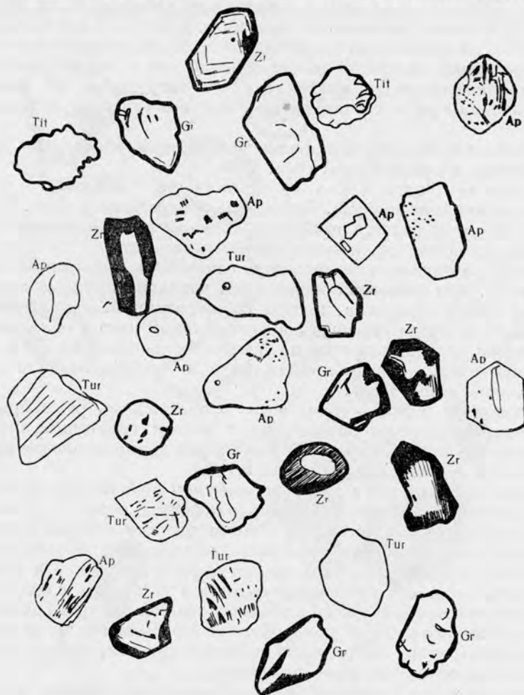
Рис. 22. Тяжелая фракция (0,1—0,05 мм) песчаника из домерских отложений Усть-Енисейской впадины в иммерсионной жидкости с N = 1,638 (обр. № 424).
