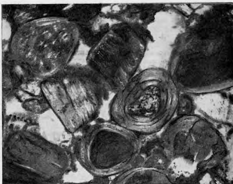
Рис. 12. Оолитовый лептохлоритовый песчаник из отложений валакжинских пород. Оолиты сложены плотным идингситоподобным минералом, оторочка — пазомзитом. Без анализатора, \times 120 .
