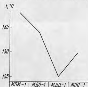
Фиг. 32. Средняя температура максимумов первого эндотермического эффекта термограмм фракций <0,001 мм
