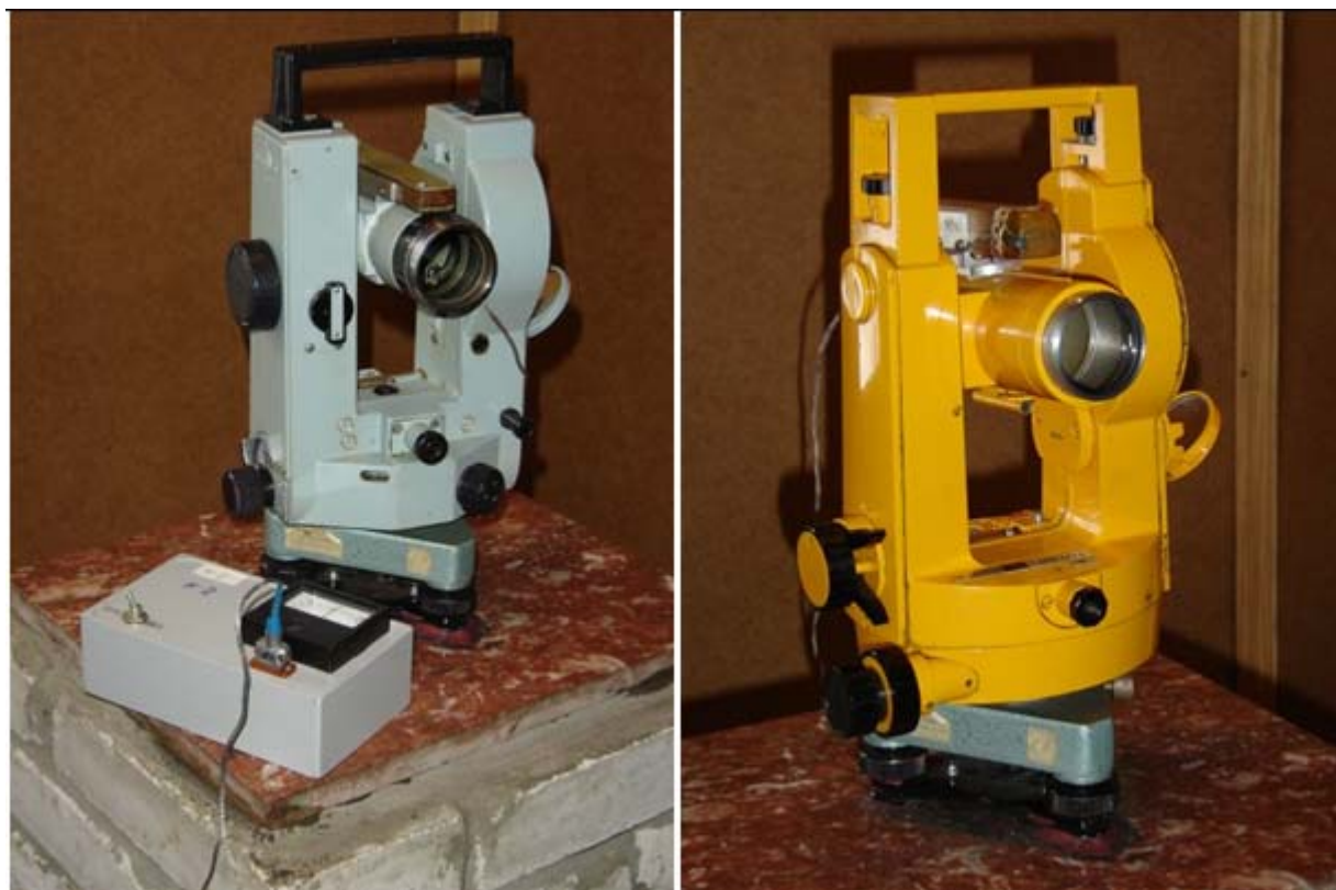
Рис. 12-24. DI-магнитометры Геофизической обсерватории «Ключи» на базе немагнитных теодолитов ЗТ2КП (слева) и Theo 020В (справа). Возле ЗТ2КП – электронный блок, на зрительной трубе теодолитов закреплены феррозондовые датчики.
