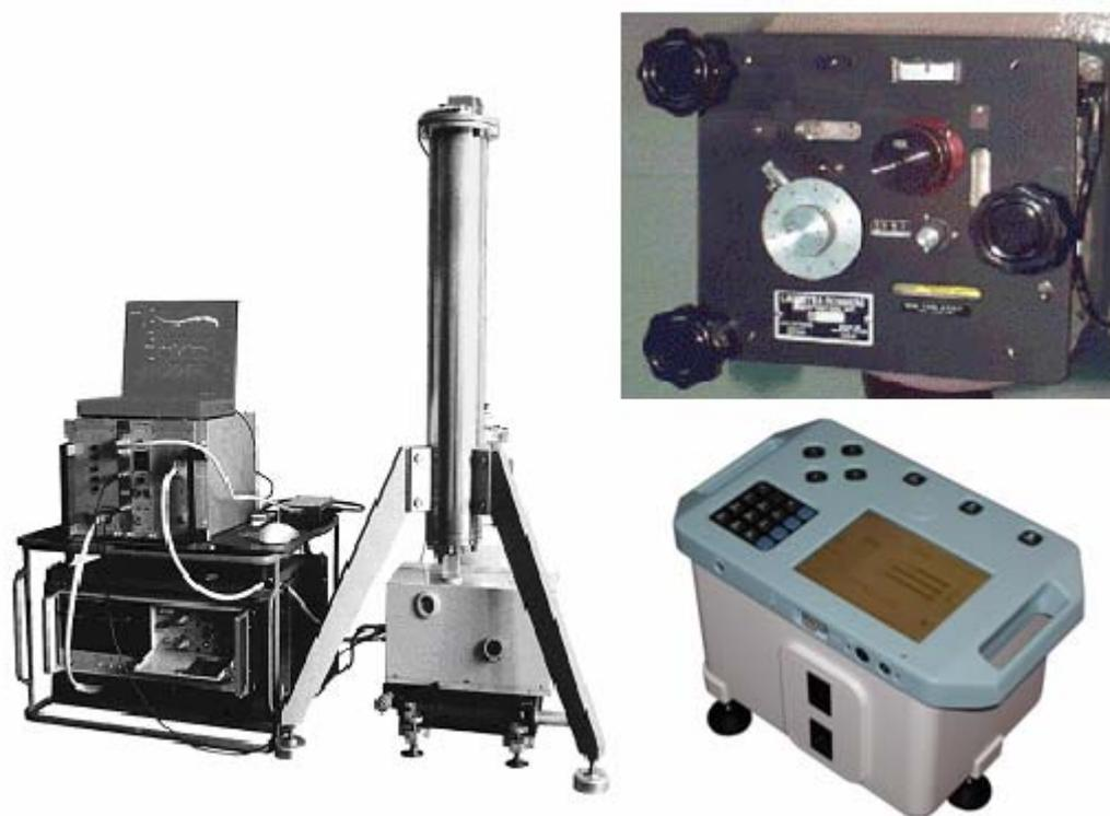
Рис. 15-3. Общий вид гравиметров: ГАБЛ (слева) и CG-3 AutoGrav (справа).
