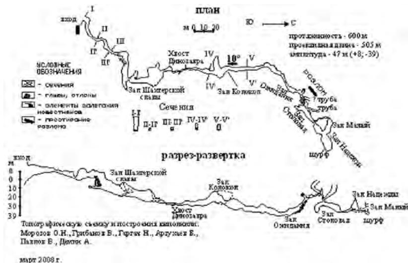
Рис. 1. План и разрезы пещеры Горомэ-1.
