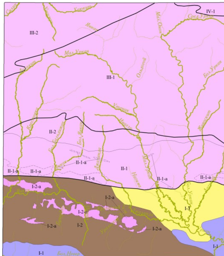
1:500 000 в 1 сантиметре 5 километров км 5 0 5 10 км 1 2 3 4 5 а б в 1 - гидрогеологические массивы; 2 - артезианские бассейны; 3 - адартезианские бассейны; 4 - бассейны трещинно-карстовых вод; 5 - границы структур: а - I порядка; б - II порядка; в - III порядка
