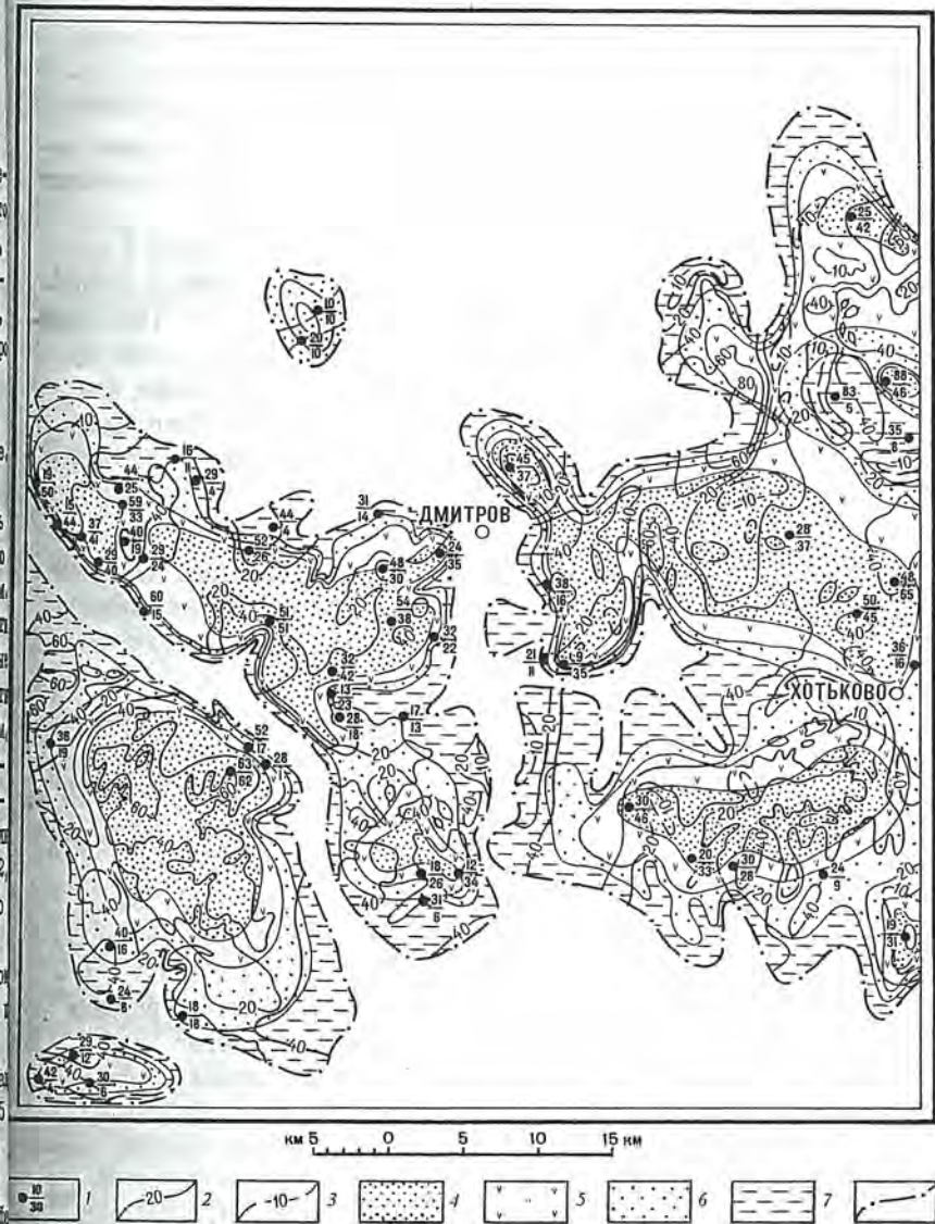
Рис. 8. Схематическая литолого-промышленная карта глин альбского яруса (парамоновских глин)
