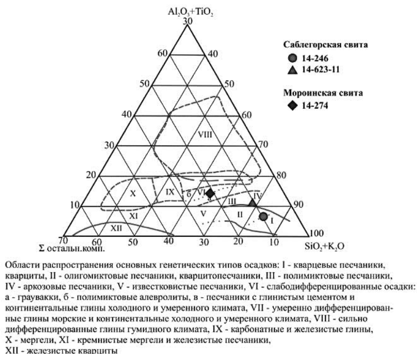
Рис. 6. Диаграмма (\text{Al}_2\text{O}_3 + \text{TiO}_2) - (\text{SiO}_2 + \text{K}_2\text{O}) по Кумпон, 1974 [32].
